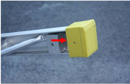
④なべ小ネジに平座金を入れ支柱の外側から内側へ差し込みます。
