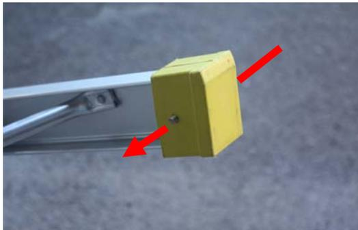
⑤内側に平座金・六角ナットの順番でなべ小ネジに入れて(⑥写真参照)内側をスパナで固定し、外側からプラスドライバーで締めていきます。
