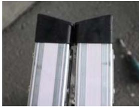
④最後にケンウキヤツのび太郎(JQN型)においては交換した端具が、反対側のズレ止めに収まるか確認し、収まればOKです。
